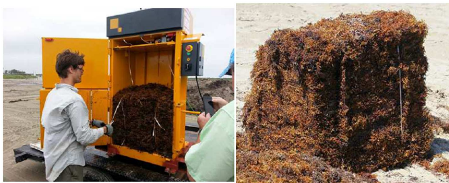
Figure 17 : Photo du prototype permettant la fabrication de ballots d'algues sargasses – source : Université de Galveston au Texas
