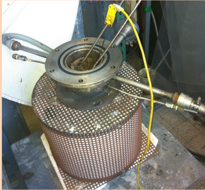
Réacteur Hydrolyse chauffé <400°C)
